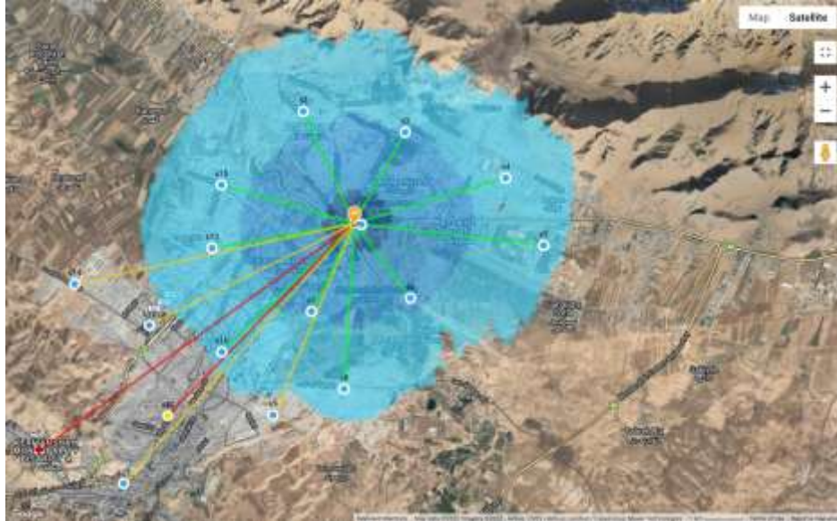
شکل ۲۸ ساختار شبکه لینک رادیویی WLAN در شهر کرمانشاه و نمونه‌ای از ارتباط دکل اصلی به مرکزیت استانداری کرمانشاه با ایستگاه‌های شتابنگاری
