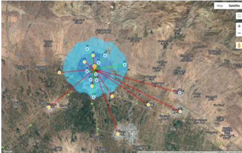
شکل ۳۰ ساختار شبکه لینک رادیویی WLAN در شهر قزوین و نمونه‌ای از ارتباط دکل اصلی به مرکزیت استاندارد قزوین با ایستگاه‌های شتابنگاری
