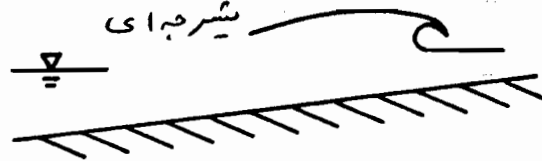
(c) COLLAPSING خوردنیختگی
